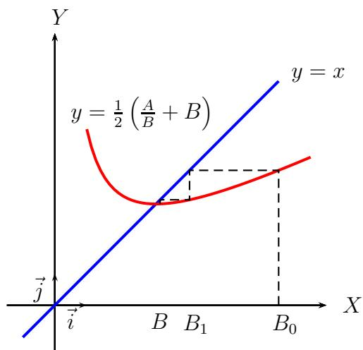
Elle converge rapidement vers  $x = \sqrt{A}$ . En regardant le schéma ci-dessus on comprend que la condition de convergence de la suite est que la courbe  $y = \frac{1}{2} \left( \frac{A}{x} + x \right)$  soit minimale en  $\sqrt{A}$ . En réalité il suffit qu'elle soit extrémale en ce point, peu importe que ce soit un maximum ou un minimum.
